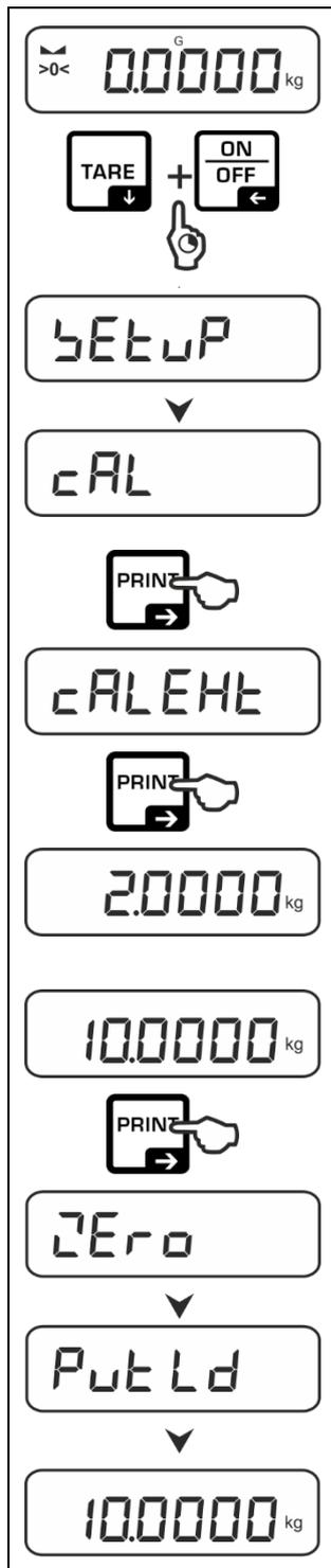
⇒ Zum Aufrufen des Setup-Menüs TARE- und ON/OFF-Taste gleichzeitig drücken und gedrückt halten.
