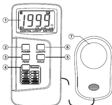
1. LCD Display: 3 ½ digits mit maximalem Ablesewert bis 1999.
