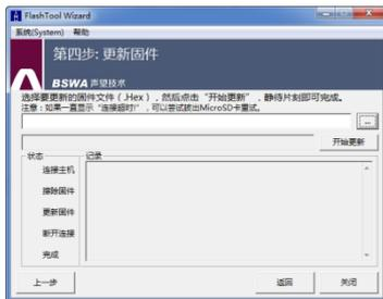
**Schritt 4:** Drücken Sie zuerst die Taste in der oberen rechten Ecke, um die Firmware auszuwählen, und dann die Taste **Update** (Aktualisieren), um das Programm zu starten. Die gesamte Prozedur benötigt 3 bis 4 Minuten.
