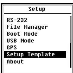
Das **Setup**-Menü enthält die Basisfunktion Setup und Bedingungsanzeige. Mit den Pfeiltasten <▲>, <▼> können Sie die Option auswählen und mit der <Eingabetaste> die nächste Menüebene aufrufen.
