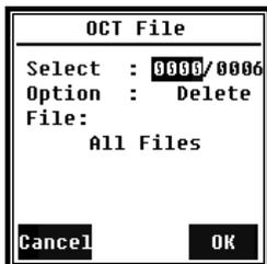
Im Menü **OCT File** (OCT-Datei) können Sie die OCT-Datei löschen. Die Bedienung erfolgt genauso wie im Menü für die **SWN-Datei**.
