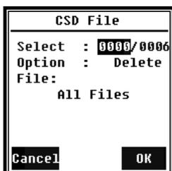
Im Menü **CSD File** (CSD-Datei) können Sie die CSD-Datei löschen, anzeigen und drucken. Mit den Pfeiltasten <▲>, <▼> können Sie den Cursor zwischen **Select** (Auswählen) und **Option** verschieben. Die Löschung erfolgt genauso wie im Menü der **SWN File** (SWN-Datei).
