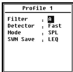
Das Menü für die Profile 1 – 3 erlaubt die Definition des Filters, des Detektors, des Modus sowie der Speicheroptionen von SWN-Dateien. Optionen können Sie mit den Pfeiltasten <▲>, <▼> auswählen.
