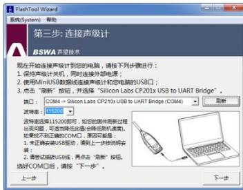
**Schritt 3:** Verbinden Sie das Schallpegelmessgerät und den Computer entsprechend der Benutzeraufforderung. Beachten Sie, dass das Schallpegelmessgerät eine externe Stromversorgung benötigt. Wenn der Treiber einwandfrei funktioniert, wählt er automatisch den **Anschluss CP210x** aus. Die Standardwert für **Baudrate** ist 115200 bps, je nach Computer. Mit einer höheren **Baudrate** lässt sich die Update-Prozedur beschleunigen.
