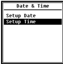
Im Menü **Date & Time** (Datum & Timer) kann die RTC-Zeit des Schalldruck-Messgeräts eingestellt werden. Drücken Sie zur Auswahl die Pfeiltasten <▲>, <▼>.
