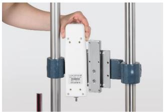
• Forzare i misuratori con sensore interno alla traversa con l'aiuto delle piastre di adattamento (4x viti cilindriche M3x8).
