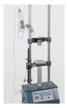
• Il misuratore di forza avvitato al banco di prova è ora collegato al banco di prova tramite il cavo RS232, collegato alla porta attrezzatura.
