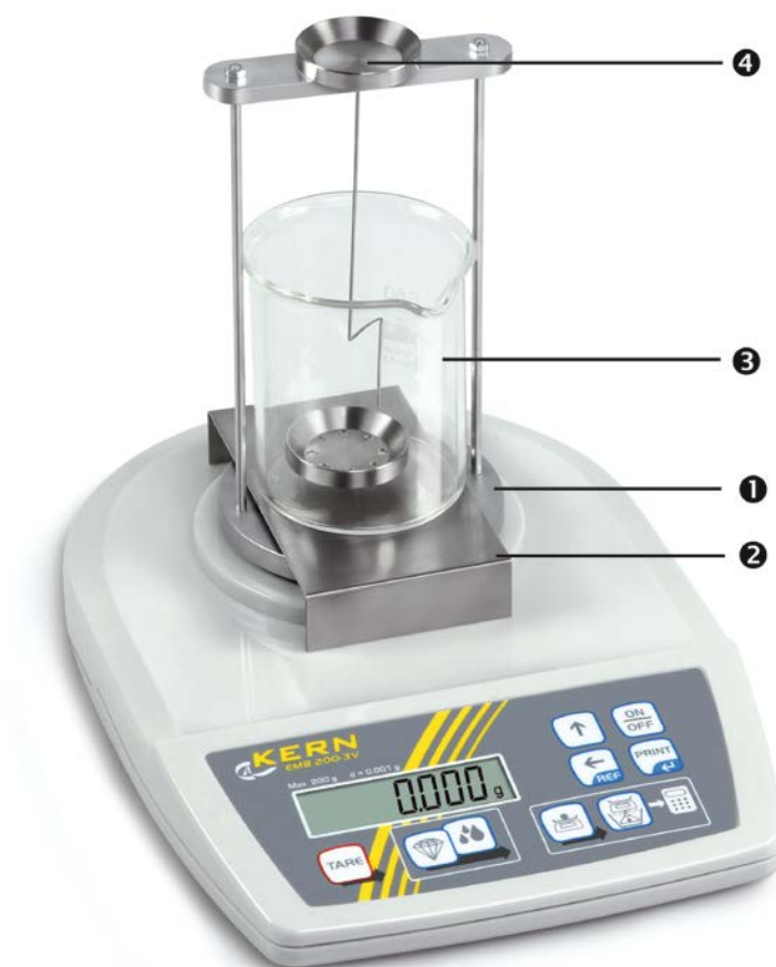
Obr. 1: Váha KERN EMB 200-3V s namontovanou sadou ke stanovení hustoty KERN YDB-01 (číslování viz část 1)
