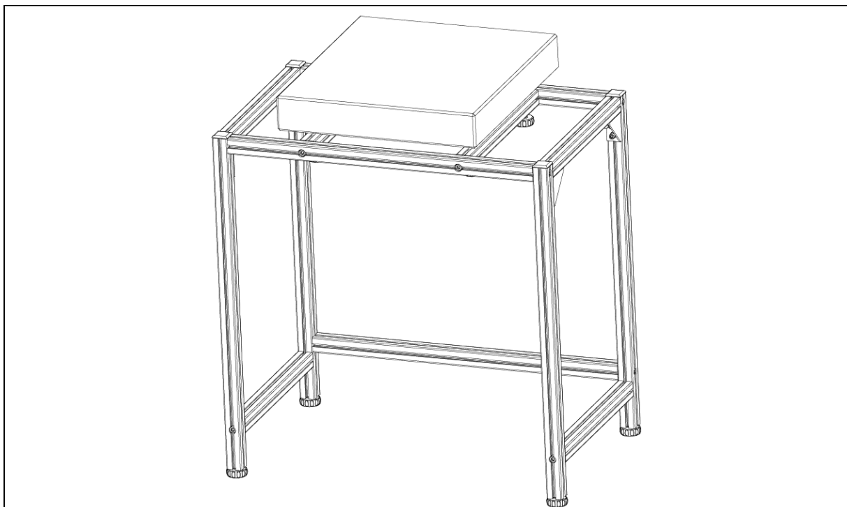
Afb. 6: Geïnstalleerd binnenframe met granietblok
