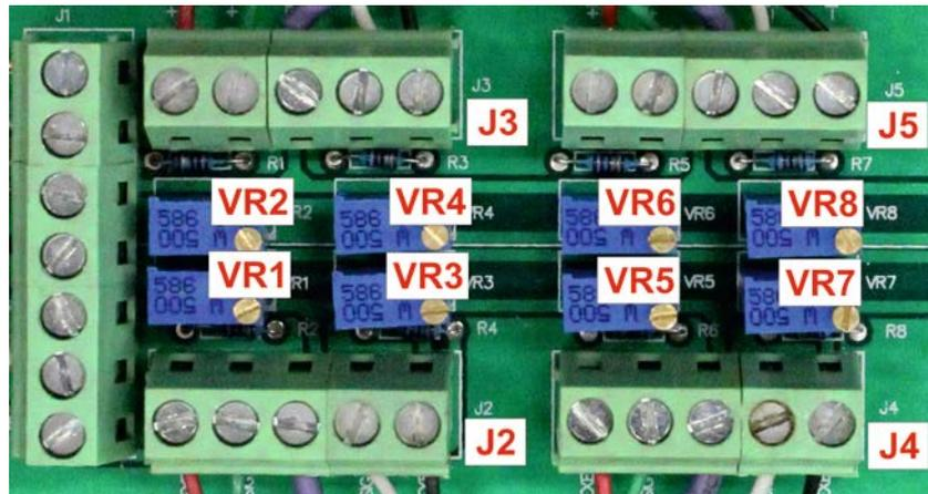
Ajustamento da célula de pesagem J2 realiza-se por meio de potenciômetros VR1 e VR2. Ajustamento da célula de pesagem J3 realiza-se por meio de potenciômetros VR3 e VR4. Ajustamento da célula de pesagem J4 realiza-se por meio de potenciômetros VR5 e VR6. Ajustamento da célula de pesagem J5 realiza-se por meio de potenciômetros VR7 e VR8. A rotação à direita aumenta o valor, rotação à esquerda diminui o valor.
