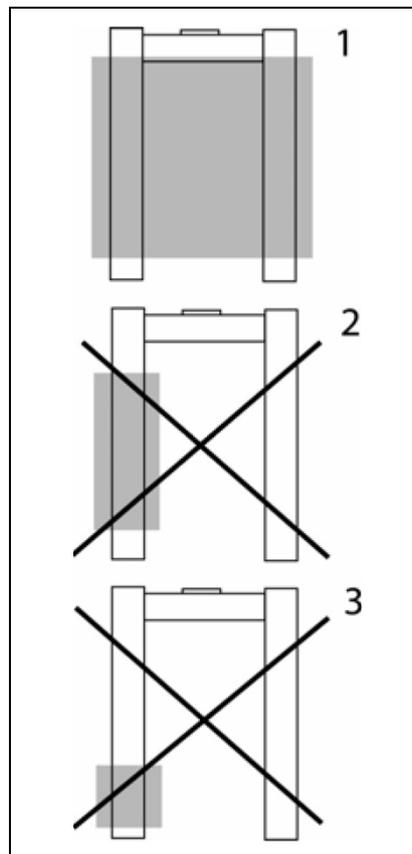
Ponte de pesagem em forma de forcado é designada para funcionar com a carga exposta uniformemente.
