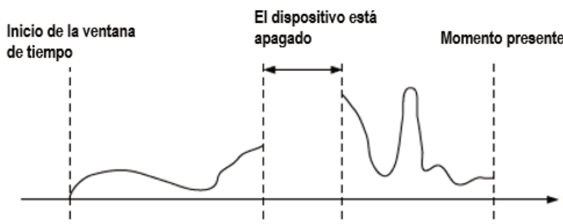
Fig. 7.136. Ejemplo de señal visualizada cuando la muestra de tiempo \geq 30\text{min}
