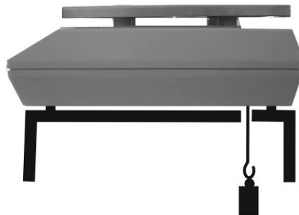
Abb. 1: Einrichten der Waage für Unterflurwägungen
