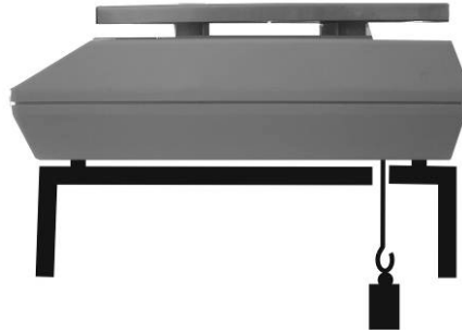
Fig. 1 : Ajustage de la balance pour les pesages en sous-sol
