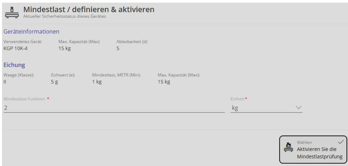
Vorgang mit dem blauen Button unten rechts „Speichern“ abschließen. Befindet sich das Gewicht auf der Wägeplatte unterhalb dieses Wertes, wird die Waage blockiert.
