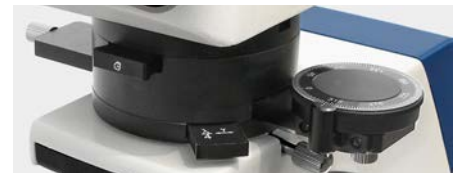
Bertrand-Linse, \lambda Slip, 360° rotierbarer Analysator (herausnehmbar)
