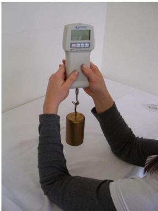
5. Esta posición se mantiene hasta que aparece "F" en la pantalla. A continuación, se puede retirar el peso y el ajuste está completo. Sin embargo, si aparece "E" en la pantalla, repita los pasos 1. a 5. **hasta que "F"** confirme que el ajuste se ha realizado correctamente.
