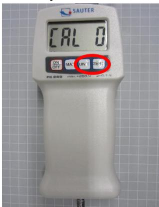
3. Después de unos segundos, la pantalla muestra el **peso de calibración** requerido, por ejemplo, 5,00kg para el FK 50 o 10,00kg para el FK 100.
