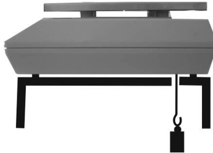
Ilustr. 1: Preparação da balança para pesagens suspensas
