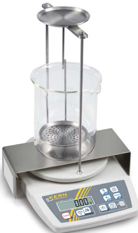
Рис. 1 Весы KERN EMB 2000-2V с установленным набором для определения плотности KERN YDB-02
