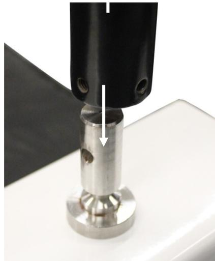
Assembler par vissage la main courante du statif avec les pièces latérales selon l'illustration
