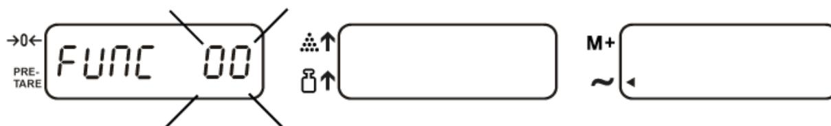
⇒ Inserire il valore "04", digitando i tasti numerici e confermarlo, premendo il tasto
