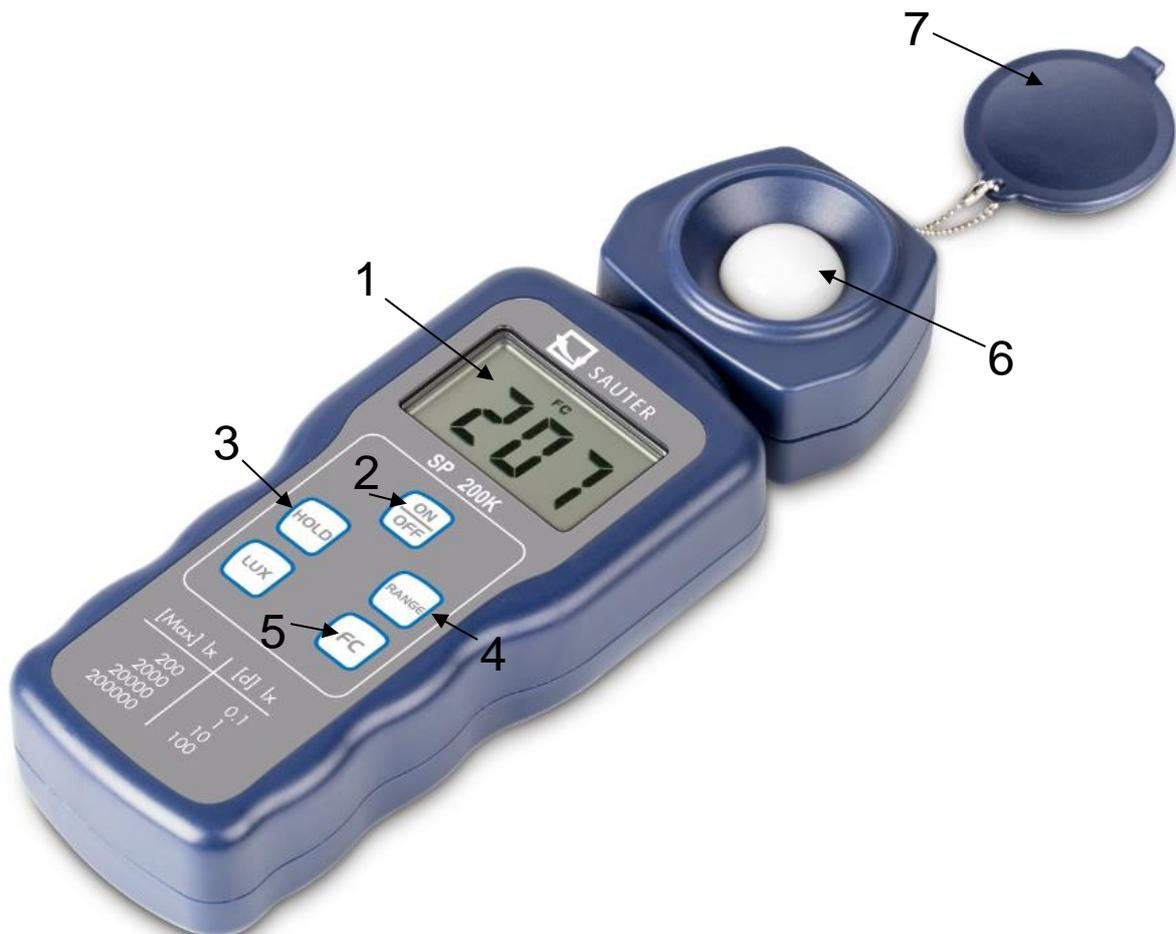
1. Affichage LCD : 3 ½ chiffres avec lecture maximale jusqu'à 1999.
