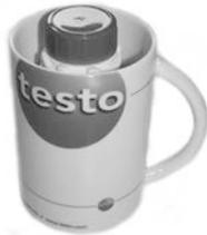
2. Calentar agua en un recipiente (una taza por ejemplo) a 50 °C. Colocar la botella de aceite de referencia durante unos 10 min en la taza con el agua caliente (altura del agua como máximo hasta el borde inferior del tapón). A continuación agitar la botella de aceite de referencia cerrada para que se reparta el calor en la botella.
