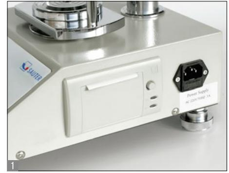
Banco de pruebas manual para pruebas de tracción y compresión de resortes, estructura mediana de 50 N a 500 N
