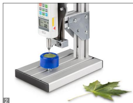
Banco de pruebas manual para mediciones precisas de la fuerza en tracción y en compresión de presión en un margen hasta 100 N
