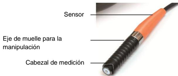
El sensor debe tocarse en el segmento inferior del eje y sólo se presiona ligeramente sobre el objeto de prueba.
