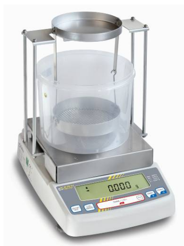
Rys. 1: Zainstalowany zestaw do oznaczania gęstości KERN PBS-A04
