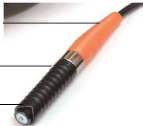
El sensor debe tocarse en el segmento inferior del eje y sólo se presiona ligeramente sobre el objeto de prueba.
