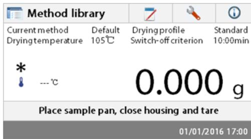
Das Feuchtigkeitsmessgerät wird mit einer vorinstallierten Standardmethode ausgeliefert. Folgen Sie dem Anweisungshinweis, um eine Messung direkt zu starten.
