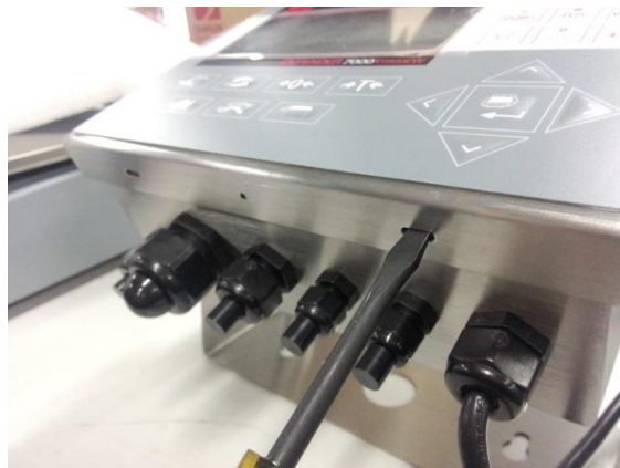
Figure 1-2: Ouverture de l'enceinte pour environnement difficile
