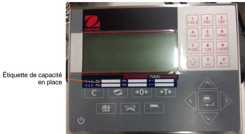
Figure 1-12: Étiquette de capacité installée
