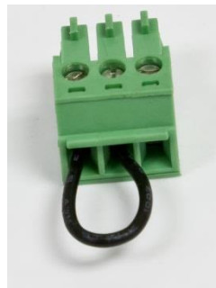
Figure 5-4 : Cavalier entre les bornes de transmission et de réception de COM1
