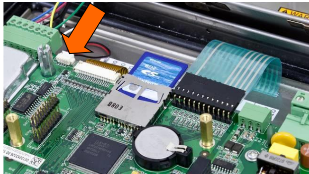
Figure 5-7: Insertion de la carte Mémoire SD
