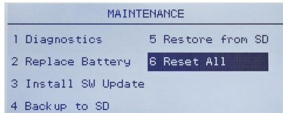
Figure 3-19 : Réinitialisation de tous les blocs de configuration
