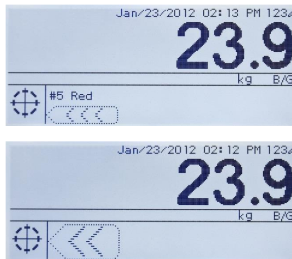
Figure 4-8: Affichage graphique SmartTrac, zones non activées : Petit (en haut) et grand (en bas)
