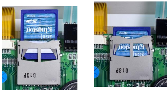
Figure 1-10: Introduction d'une carte SD dans le support SD (à gauche) ; carte SD installée (à droite)
