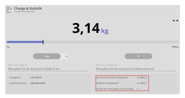
Wägeplatte entlasten, zweites Element auflegen, das Gewicht dieses Elements wird angezeigt.
