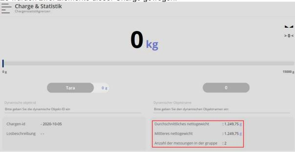
Auf Button "Pause" klicken. Die bisher erfassten Werte werden gespeichert und die Waage wechselt zur Nullanzeige. Gewünschte Funktion, mit der gearbeitet werden will auswählen und damit arbeiten.
