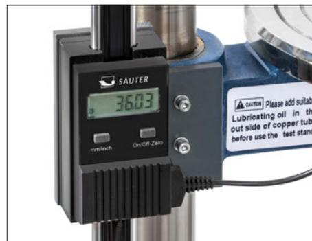
Pied à coulisse de précision à monter dans les machines et installations avec interface de données RS-232
