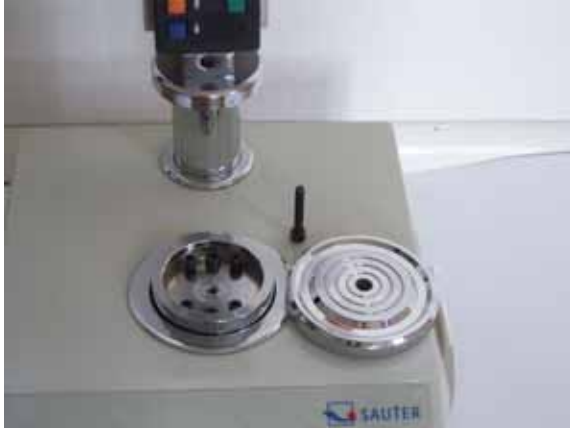
c. Fissare il telaio sul basamento e collocare la piastra di base sul telaio
