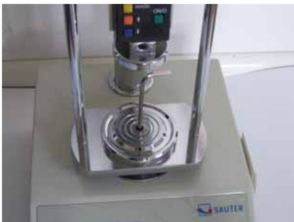
d. Fissare la piastra di base (con la vite nera)
