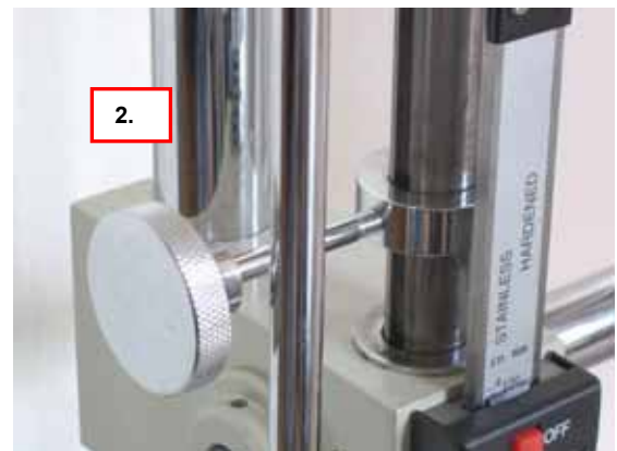
g. Avvitare la vite di impugnatura media (2.) nel morsetto per limitare la corsa
