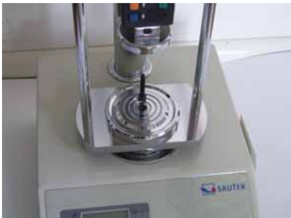
d. Fissare la piastra di base (con la vite nera)
