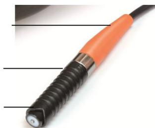
Le capteur doit être touché au niveau du segment inférieur de l'arbre et n'est que légèrement pressé sur l'objet à tester.
