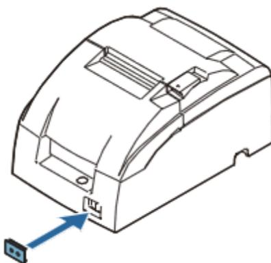
La protezione fornita dell'interruttore "ON/OFF" evita uso involontario dell'interruttore. Per installarla bisogna semplicemente ficcare la protezione sopra l'interruttore. Per accendere o spegnere il dispositivo attraverso l'interruttore "ON/OFF" con la protezione installata, bisogna usare un oggetto fine che va ficcato in uno dei fori praticati nella protezione.
