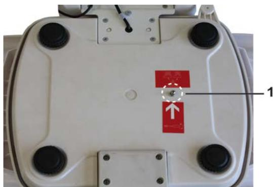
Para afrouxar a proteção de transporte, desaparafusar o parafuso de transporte [1] no sentido inverso aos ponteiros do relógio.
