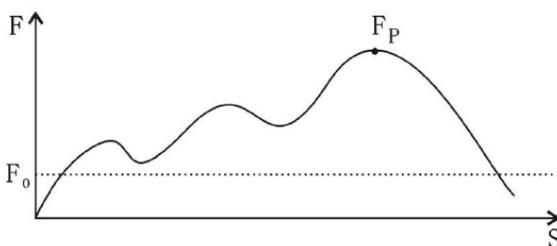
Questa funzione è utilizzata nelle misurazioni durante le quali si verificano indesiderati valori picco preliminari “Pre-Peak” più bassi del valore picco ricercato ( $F_P$ ). Il valore picco impostato ( $F_0$ ) evita il salvataggio dallo strumento di misurazione del valore “Pre-Peak”.
