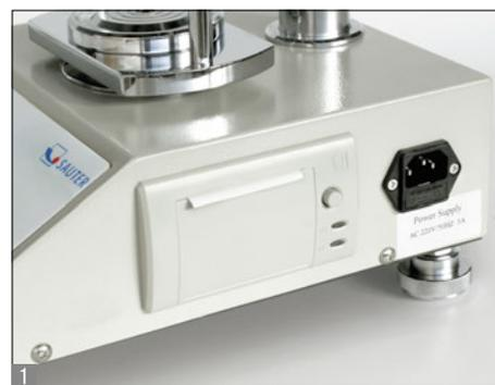
Banco di prova manuale per prova di trazione e compressione su molle, formato medio da 50 N a 500 N
