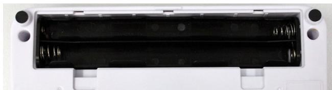
Insertar las pilas en el compartimiento de las pilas y cerrar la tapa.
