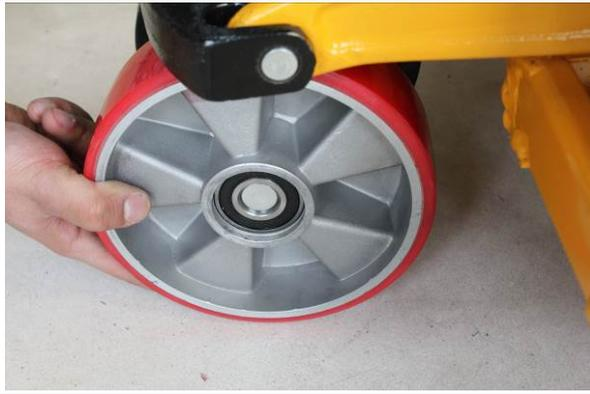
Ajustar la rueda giratoria autoajustable con revestimiento de poliuretano.
