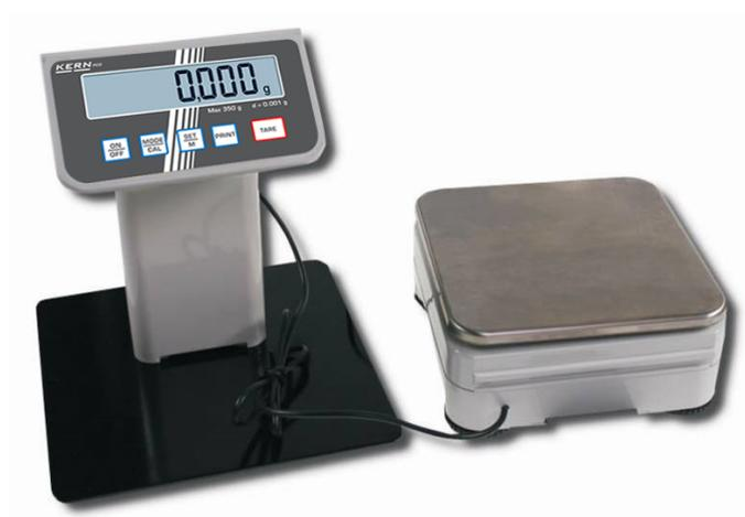
Instalar a balança de tal modo que o prato de pesagem fique exatamente na posição horizontal.
