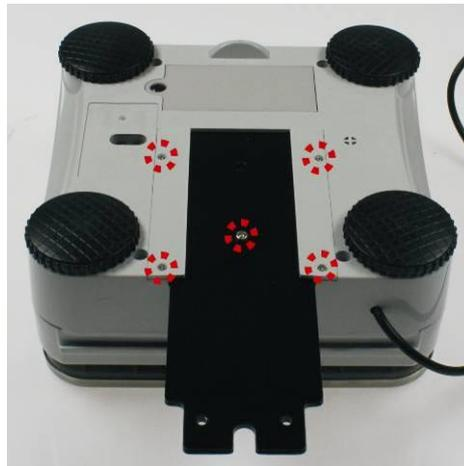
Para desmontar a chapa de montagem, retirar os parafusos marcados desaparefusoando-os. Depois o visor pode ser colocado separadamente.
