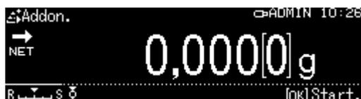
⇒ Coloque o primeiro material a ser pesado. Após o controle de estabilização bem-sucedido (→), o valor pesado será automaticamente transferido para uma impressora opcional. O valor de indicação será adicionado à memória de soma. Em seguida, ocorre a definição de tara automática.
