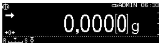
⇒ Coloque o material a ser pesado, aguarde a exibição dos marcadores de tolerância **HI**, **OK** ou **LO**. Usando os marcadores de tolerância, verifique se o peso do material a ser pesado está dentro da tolerância especificada.
