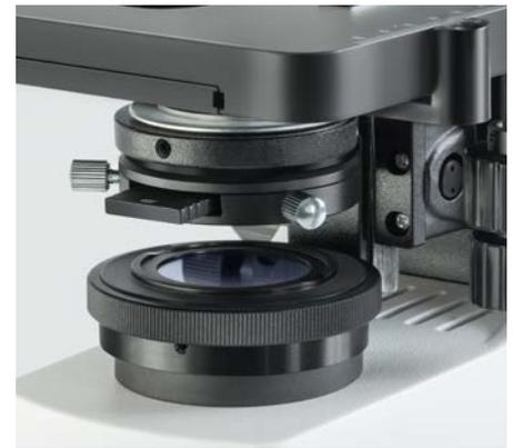
Condensatore a contrasto di fase montato
