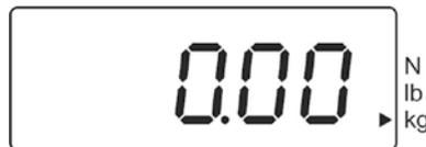
⇒ Mantener presionada la tecla **Unit** (aprox. 15 s) hasta que aparezca la indicación “CAL”.
