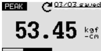
Pulse las teclas de flecha ARRIBA o ABAJO para cambiar la máscara de memoria. Mantenga pulsada la tecla para desplazarse hasta la posición del cambio de máscara de memoria. Si se pulsa la tecla PRINT, se imprimirán los datos almacenados y transmitidos a través del puerto serie. Para entrar en la máscara del menú *BORRAR*, pulse la tecla ZERO.
