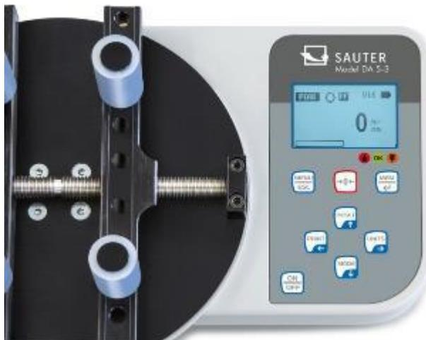
Para encender el aparato, pulse la tecla ON/OFF. Tras un breve autotest, la pantalla muestra el valor de carga admisible en Newtons.
