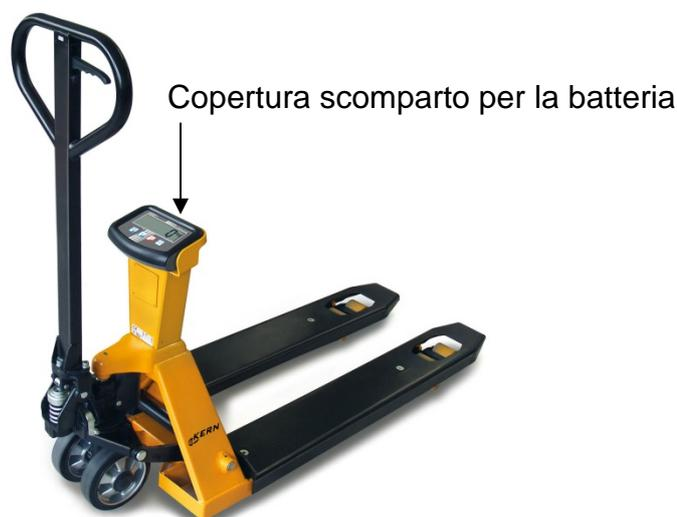
Per sostituire le batterie svitare e rimuovere il coperchio del vano batterie sul lato posteriore del dispositivo di visualizzazione. Sostituire le batterie scariche con batterie nuove (4 batterie da 1,5V AA) (fare attenzione alla polarità corretta) e rimettere il coperchio delle batterie.
