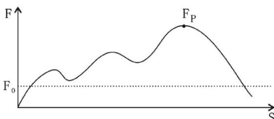
Diese Funktion wird bei solchen Messungen eingesetzt, bei denen unerwünschte „Vor-Peaks“ auftreten, die unterhalb des gesuchten Peak-Wertes (Fp) liegen. Der einstellbare Grenzwert (Fo) verhindert, dass das Messgerät die „Vor-Peaks“ abspeichert.
