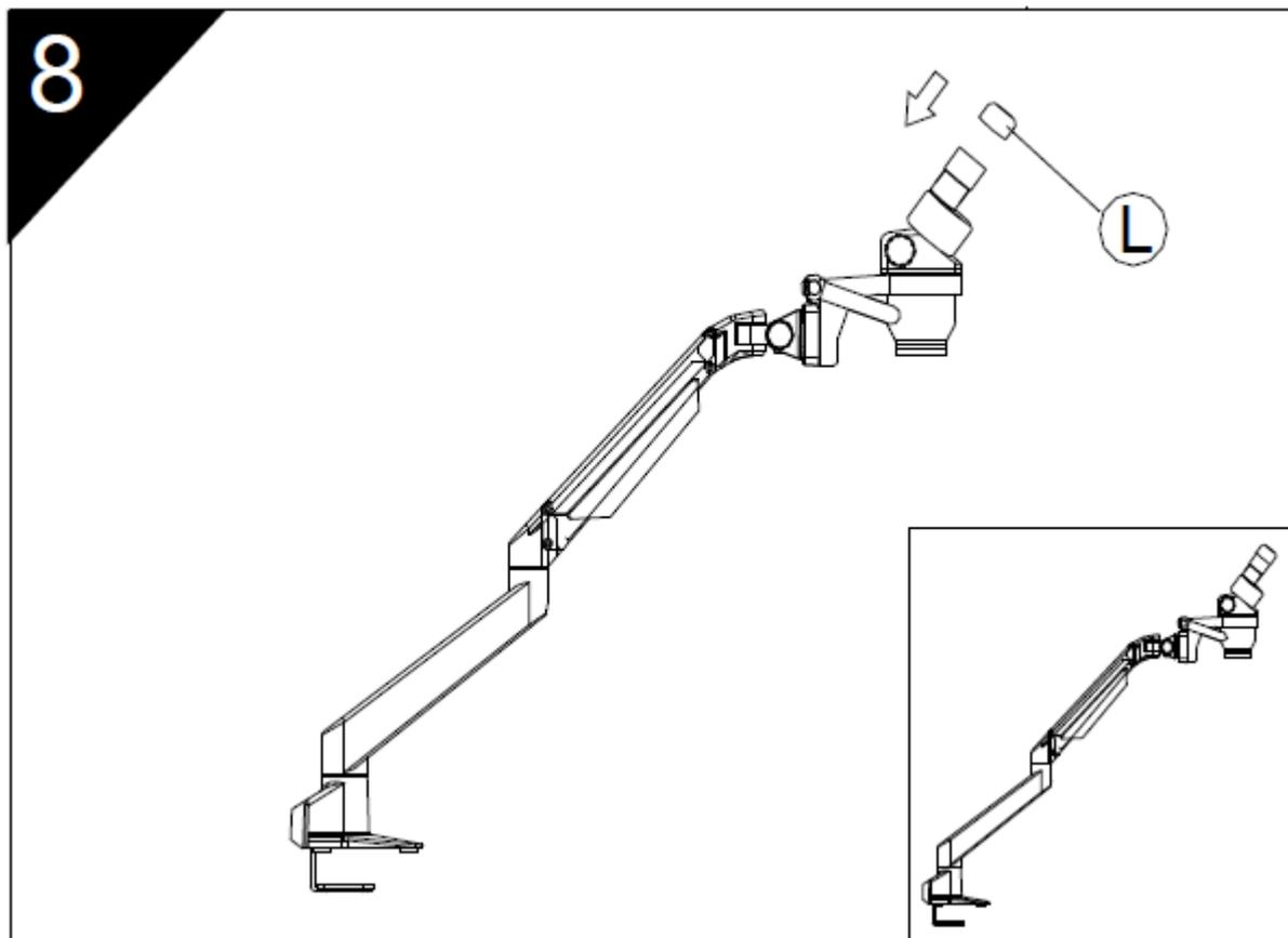
Pour assurer l'**éclairage de la lumière incidente**, l'illuminateur annulaire à DEL doit être fixé au bas du boîtier de l'objectif de la tête du microscope. Les **trois vis de fixation sur le support de l'unité d'éclairage** servent à la fixation.
