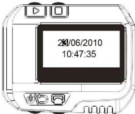
Im Sekunden- Einstellprozess angelangt, wird durch Betätigen der Taste
