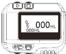
Jetzt werden 5 Tests auf dem Prüfblock gemacht, um den Mittelwert derselben zu erhalten.
