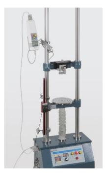
• Il misuratore di forza avvitato al banco di prova è ora collegato al banco di prova tramite il cavo RS232, collegato alla porta attrezzaura.
