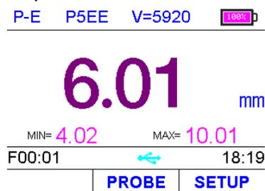
**Modo Diff. [Diff mode]** Se muestran tanto la última lectura de espesor como el valor diferencial de espesor (a partir del valor de espesor absoluto y del valor de espesor nominal).
