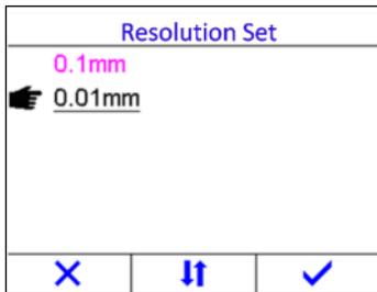
Cuando la resolución se ajusta a 0,01 mm, la superficie de la pieza de ensayo debe ser lisa para obtener resultados de ensayo precisos. Cuando se miden superficies rugosas o materiales de grano grueso, se recomienda utilizar la resolución baja.
