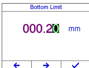
Pulse la tecla
