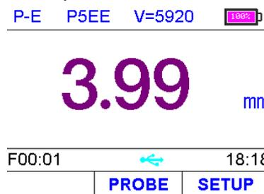
**Modo de escaneo [Scan mode].** Además del último valor de medición del espesor, también se muestran los valores de espesor mínimo y máximo durante la medición.
