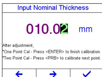
Figura inferior: Medición del segundo punto durante la calibración de dos puntos.
