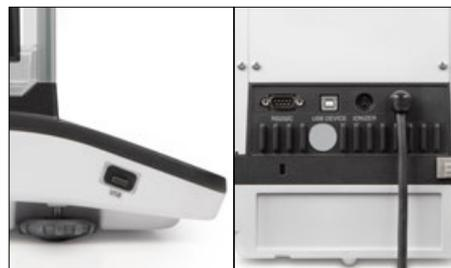
**Interfaz de datos USB y RS-232** para transferir datos de pesaje a PC, tablet, impresora y para conectar dispositivos externos, como escáner de código de barras (opción), teclado numérico (opción), etc.
