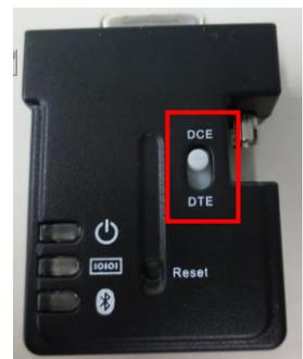
**i** Für die Konfiguration über den Computer ist das Gerät direkt mit dem Rechner zu verbinden und der Schalter auf DCE zu stellen.
