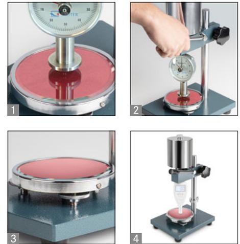
Banc d'essai à levier pour contrôles de dureté reproductibles avec plaque de base en verre
