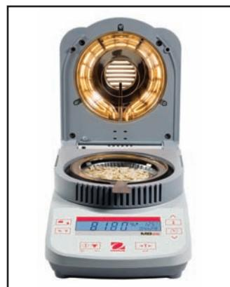
Das OHAUS-Modell MB23 ist mit einem Infrarot-Heizelement ausgestattet, während das Modell MB25 Halogen-Technologie einsetzt.
